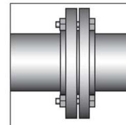
Готовые фланцы K-FLEX IN CLAD состоят из двух секций изоляционного материала K-FLEX, покрытых листом IN CLAD черного или серого цвета. Они имеют самоклеящийся нахлест для фиксации между собой вдоль линии стыка.
