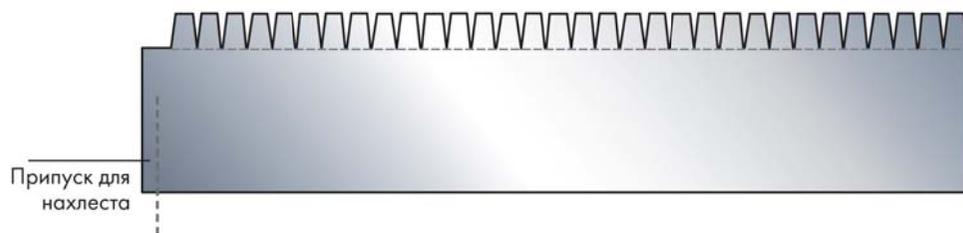
Нанесите двухкомпонентный клей на лепестки и загните их на торец фланца (**e2**).
