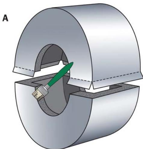
**A)** Нанесите клей K-FLEX на швы теплоизоляционного материала.
